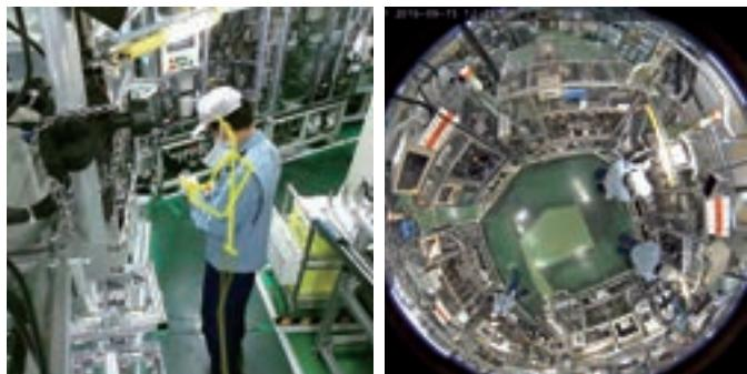
左) センシング技術により現場作業員の関節位置を測定
