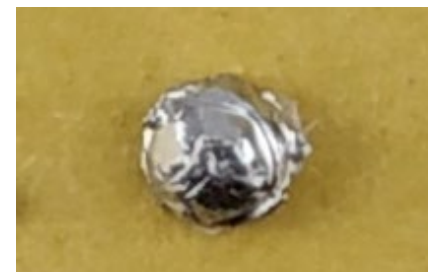
金属吸着剤で取り出したパラジウム
