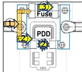
定格電流は性能の高いPyro Fuseが負担し、消弧性能は性能の高いヒューズが担う。組み合わせることで、小型化が可能
