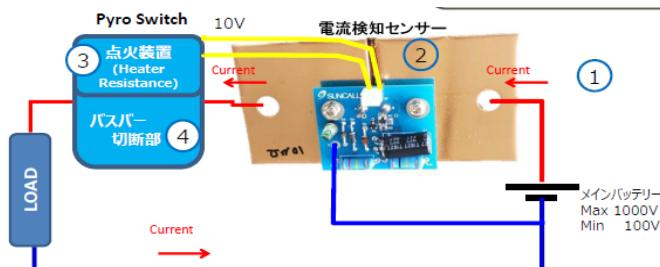
デバイスに搭載したセンサーにて既定の電圧もしくは電流値以上になれば自動的に瞬時に遮断可能
