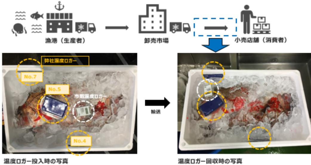
図5 2020年10月に実施した柏の葉スマートシティ周辺での鮮魚物流の温度モニタリングの実証実験の概要
