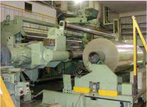
シート成形設備
