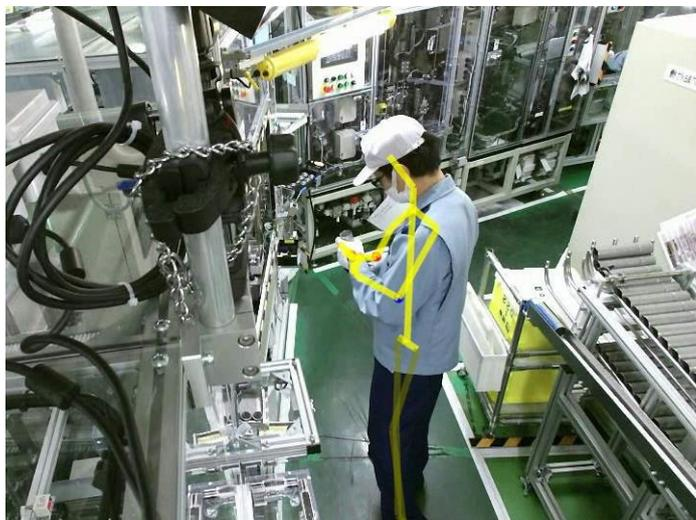
画像解析システムを用いた現場作業員のセンシング例
