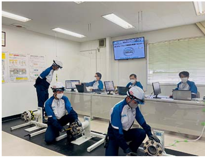
画像2 シミュレーターによる科学的なフランジ締付けトレーニング
