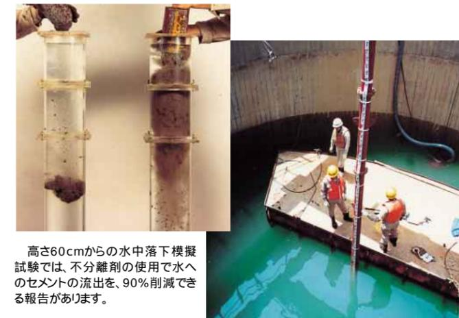
高さ60cmからの水中落下模擬試験では、不分離剤の使用で水へのセメントの流出を、90%削減できる報告があります。
