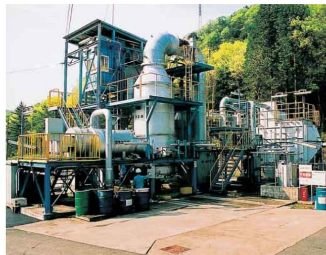
回収インフレーター作動処理設備
