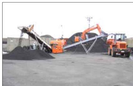
セメント原料化のため廃タイヤ燃焼燃えがら(ボトムアッシュ)を処理している現場
