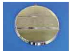
優れためっき外観に加えて高い耐熱性(200)を有しています。樹脂装飾めっきは、エンブレム、ラジエーターグリルなどの自動車部品、水道・水廻り部品、遊戯機器など、幅広い用途に使用されています。
